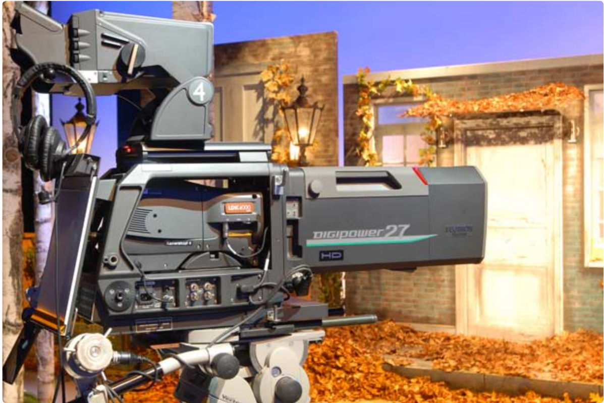
Das HA27x6.5BESM kommt beim Übertragungswagen 1 des NDR mit Grass Valley LDK 4000 Elite HD-Kameras zum Einsatz.
