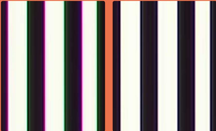
Bild 3a zeigt eine sichtbare chromatische Aberration an einem S/W-Liniennaster mit sehr hohem Kontrast. Der stark vergrößerte Bildausschnitt stammt vom rechten äußeren Bildrand. Bild 3b zeigt das Raster an derselben Position mit zugeschalteter ALAC-Funktion.
