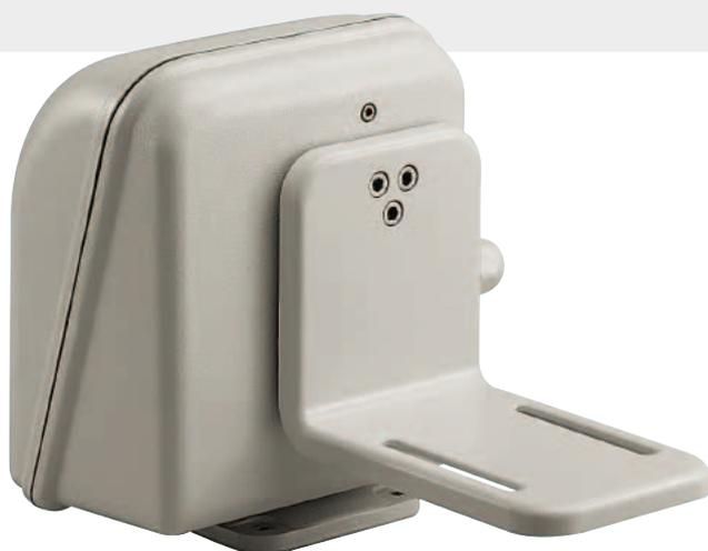
Die Schwenk-Neige-Köpfe dieser Familie besitzen eine Struktur aus Aluminiumdruckguß, die mit Epoxypulver RAL9002 beschichtet wird. Die Einrichtungen sind für mittlere Lasten (max. 30kg ausbalanciert) ausgelegt und für die Installation im Freien oder unter besonders erschwerten Bedingungen geeignet.
