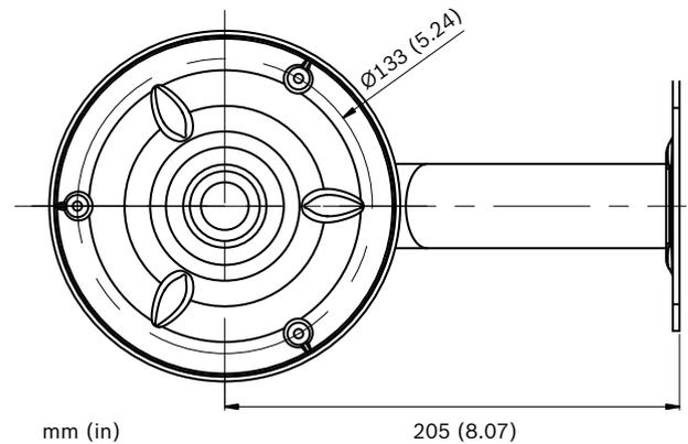
**VDA-PMT-DOME – Hängende Rohrhalterung**
