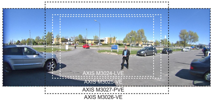
Links: Horizontale Blickwinkel. Rechts: Ungefähre Sichtbereiche (AXIS M3027-PVE: Wandmontage, Panoramablick)
