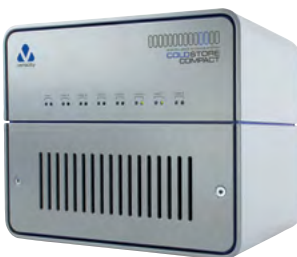
COLDSTORE Compact ist außerdem verfügbar mit 8 x 2,5 Zoll Laufwerken mit bis zu 16 TB Speicherkapazität - bei nur 16 W.
