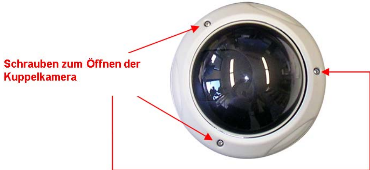
Bild 1: Öffnen des Kameragehäuses
