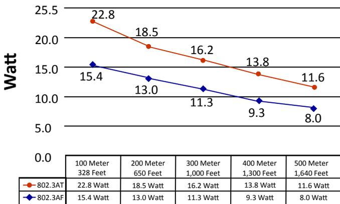
\*Ergebnisse kartiert wurden berechnet unter Verwendung RG59U Koaxialkabel mit einem 20 AWG Innenleiter und Power Sourcing Equipment mit IEEE 802.3af-Standard mit Start-Spannung von 48 Volt DC und IEEE 802.3at Standard mit Zündspannung von 54 Volt DC
