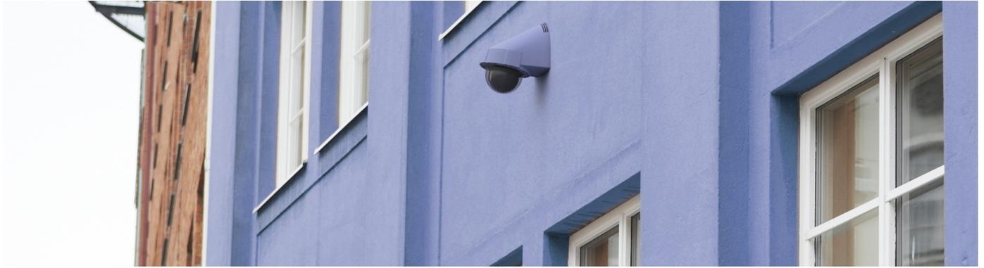
Die AXIS P54-Serie bietet ein intelligentes, direkt angetriebenes Schwenk- und Neigesystem sowie ein neues Design für die Wandbefestigung von PTZ-Kameras, das eine einfache und diskrete Installation ermöglicht.
