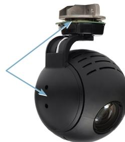
Eine AXIS P54-E-Kamera wird direkt an der Antriebswelle zweier Motoren (im Bild links durch Pfeile markiert) angebracht. Ein Motor dient zum Schwenken, der andere zum Neigen der Kamera. Da keine Bauteile wie Riemen oder Zahnräder vorhanden sind, bietet die AXIS P54 ein strapazierfähiges und schnelles Schwenk- und Neigesystem, sodass die Kunden über eine zuverlässige und wartungsarme PTZ-Kamera verfügen.
