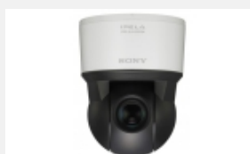
SNC-ZR550 Rapid-Dome-Kamera mit 720p/30 Bildern/s, die analoge Video- und IP-HD- Bilder über Ihre bestehende analoge Koaxialinfrastruktur übertragen kann
