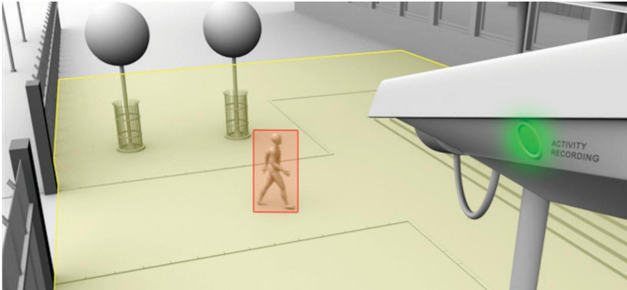
Oben: Zuverlässige Detektion von sicherheitsrelevanten Objekten oder Ereignissen mittels vordefinierbarer Zonen sowie Übermittlung von Event- und Metadaten an IPS VideoManager zwecks Anzeige, Aufzeichnung und Alarmbearbeitung.
