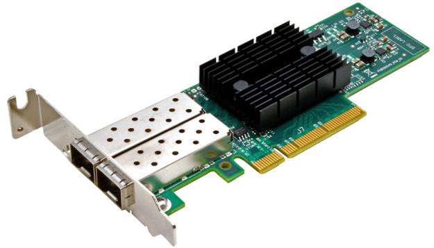
Synology E10G17-F2 ist ein 10 Gigabit PCIe 3.0 x8 Ethernet-Adapter mit zwei „SFP+“-Ports, der speziell für NAS-Server der Serien XS+/XS von Synology entwickelt wurde. Mit Unterstützung für CPU Offload (RDMA over Ethernet)<sup>1</sup> erfüllt die E10G17-F2 auch höchste Leistungsanforderungen. Die Synology E10G17-F2 wird durch eine 5-jährige eingeschränkte Garantie von Synology abgedeckt.
