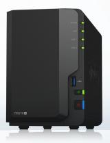
Die Synology DiskStation DS218+ besitzt einen Dual-Core-Prozessor mit AES-NI-Verschlüsselungsbeschleunigung und ein Transkodierungsmodul, das für Dateiübertragungen in Hochgeschwindigkeit sorgt und die 4K-Transkodierung in Echtzeit unterstützt. DS218+ ist ideal, um kritische Assets zu schützen und Dateien über große Plattformen hinweg freizugeben. Die Synology DS218+ wird durch eine 2-jährige, eingeschränkte Garantie von Synology abgedeckt.
