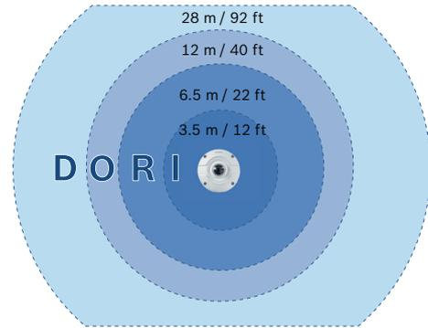
Bei einer Befestigung in 3 m Höhe hat die 360° Version der Kamera nachfolgenden Abdeckungsradius für die vier Stufen:
