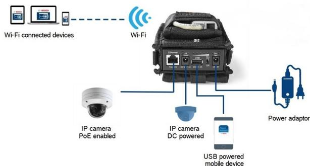
Anschluss für tragbares Kamera-Installationstool
