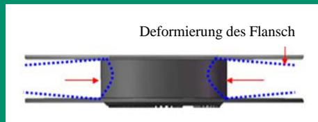
Verjüngter Bandspulenflansch: Die innere Oberfläche des Bandspulenflansches beinhaltet oben und unten eine Kegelform. Diese vermeidet, dass das Datenband während der Benutzung Kontakt mit dem Flansch hat. So wird das Datenband geschützt.
