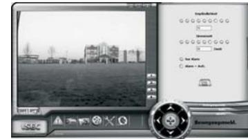
Bei dieser Art der automatischen Aufnahme wertet die Software Änderungen im gewählten Bild aus, um Bewegungen im Bild zu erkennen. Bei Bewegungserkennung kann ein Alarmton vom PC ausgelöst werden und eine Aufnahme stattfinden.
