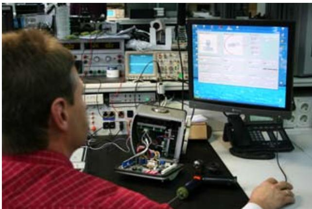
*Zum Abschluss der Reparatur wird der Schwenk/Neigekopf noch einmal einem genauen Funktionstest unterzogen.*
