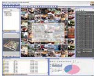
Mit dieser leistungsstarken Software lassen sich bis zu 64 benutzerdefinierte Oberflächen einrichten, Lagepläne von größeren Gebäudekomplexen integrieren oder Alarmereignisse überprüfen, die von Feuer-, Einbruch oder Bewegungsmeldern angezeigt werden („Pager Event Notification“).
