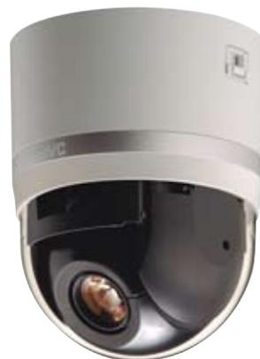
Die TK-C686E bietet darüber hinaus einen erweiterten Dynamikbereich; der digitale Signalprozessor sorgt dafür, dass helle Bereiche der Aufnahme fläche im High-Speed-Shutter-Modus, dunkle Bereiche dagegen im Normal-Shutter-Modus belichtet werden. Nach dem Auslesen beider Bilder werden sie zu einem einzelnen Bild zusammengesetzt, in dem sowohl die hellen als auch die dunklen Bildbereiche perfekt belichtet sind.
