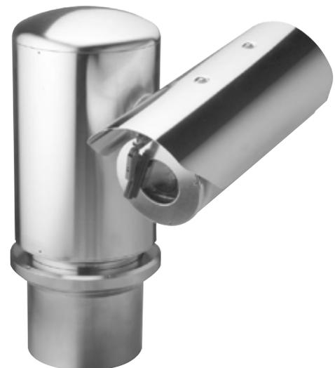
Die ExSite Serie bietet variable Schwenk- und Neigegeschwindigkeiten von 0,1° bis 40° pro Sekunde im manuellen Schwenk-, Neige- und Preset-Modus. Selbstverständlich ist eine 360° kontinuierliche Rotation möglich. Der Schwenkbereich liegt bei -90° bis +90°, wobei bis zu 80 Festpositionen gespeichert werden können, die mit einer Genauigkeit von  $\pm 0.1^\circ$  angefahren werden.
